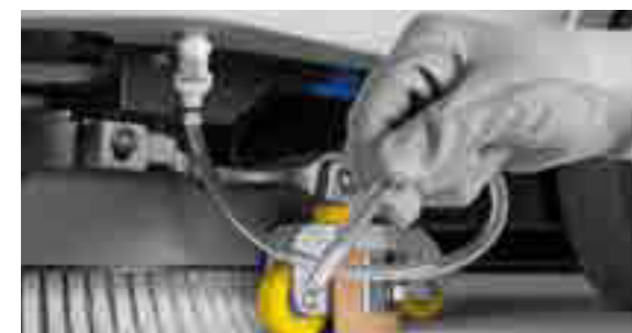
Auch das Ablassen des im Reinigungslösungstank vorhandenen Wassers kann praktisch und schnell mithilfe des entsprechenden Ablaufschlauch durchgeführt werden, der sich im vorderen Teil der Scheuersaugmaschine befindet.
