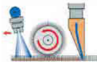
Spray X 12 brush: die Reinigungsleistung wird durch die Walzenbürste verstärkt.
