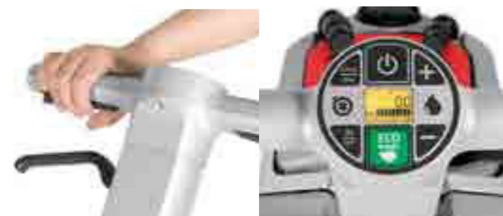
Bequemes und praktisches Ein- und Aushaken der Bürste: einfach drei Mal die Totmannhebel drücken und das Entriegeln zum Entfernen der Bürste am Display der Vispa EVO bestätigen.
